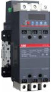
CPX1.2…CPX100控制与保护开关主要适用于交流50Hz或60Hz，额定工作电压为400V，额定绝缘电压1000V，对线路进行控制与保护，或用于控制电动机起动、停止、正转、反转等，开关具有过载、起动、短路短延时、短路瞬时保护功能及断相或三相不平衡、剩余电流保护、过压和欠压等保护功能。
